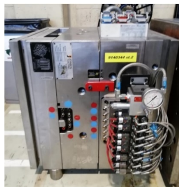
安裝熱流道 模具以減少 廢料，每年 節省 25 噸 塑料原料
